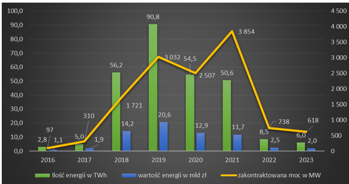
Rys. 1. Łączna moc zainstalowana elektryczna instalacji [MW], ilość sprzedanej energii [TWh] oraz wartość sprzedanej energii [mld zł] wytwórców, którzy wygrali aukcje OZE w latach 2016-2023
