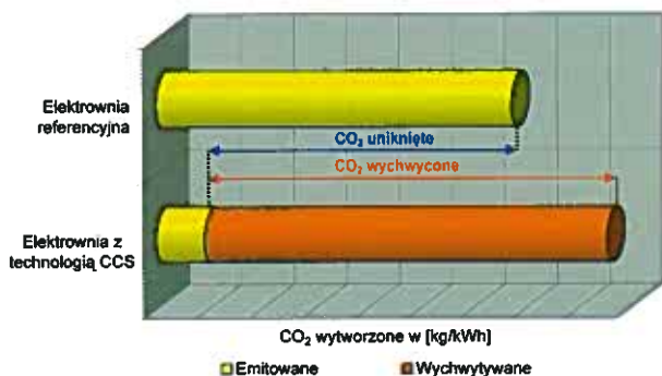
Rysunek 8. Redukcja emisji CO 2 przy zastosowaniu technologii CCS (Źródło: opracowanie własne na podstawie Special Report on Carbon dioxide Capture and Storage, Summary for Policymakers, IPCC 2005 )
