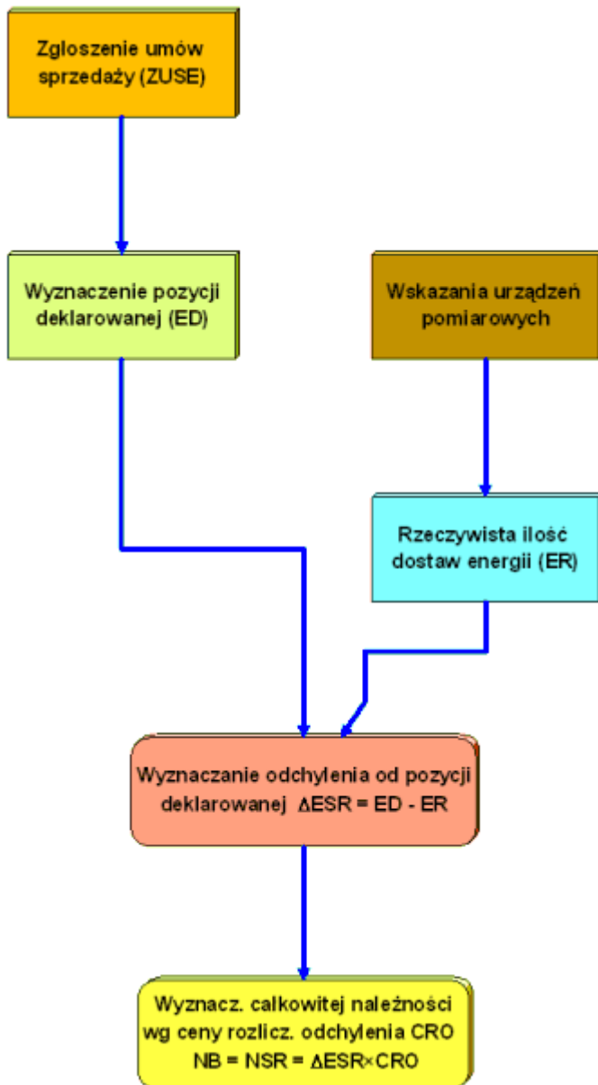
Rys. 1.10 Procedura rozliczeń jednostki grafikowej nieaktywnej
