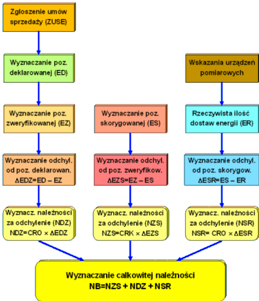
Rys. 1.9 Procedura rozliczeń jednostki grafikowej wytwórczej aktywnej
